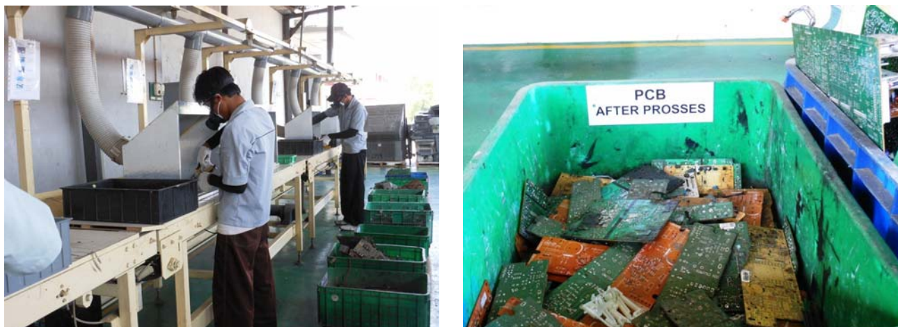
写真 3.2.1 Mukti 社 e-Waste の解体作業（左）と解体された PCB（右）（調査時撮影）
